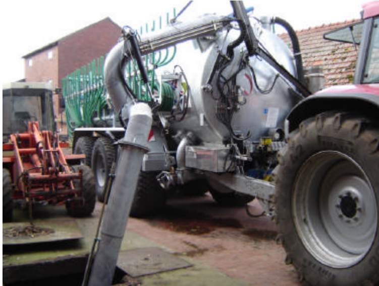
Multifunktions-Saugrüssel von Kotte im Einsatz an der Grube
