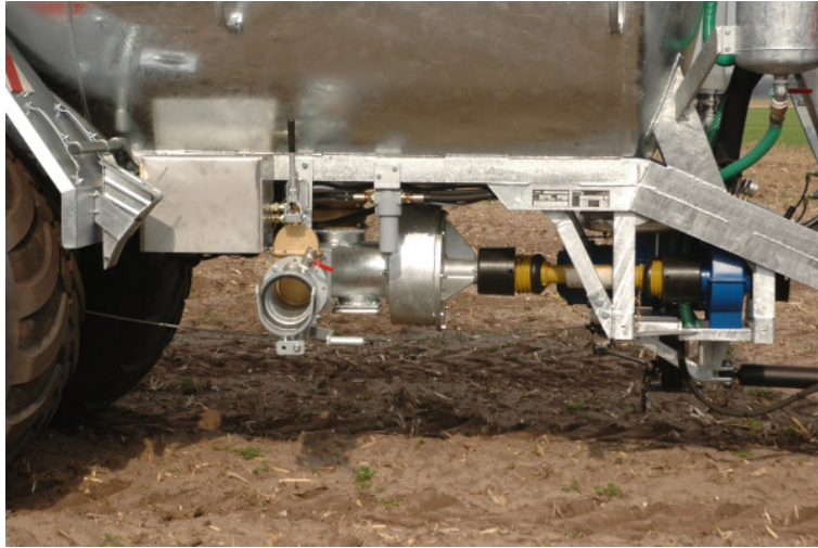
Bild 1: Power-Boost-Technik 1.0 mit Nebenantrieb vom Kompressor
