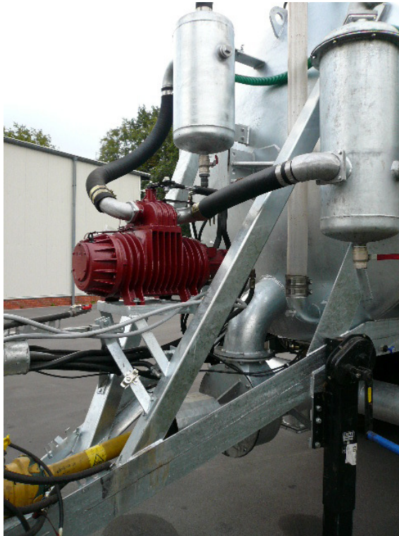
Bild 3: Power-Boost-Technik 2.0 mit hydraulisch angetriebenem Kompressor
