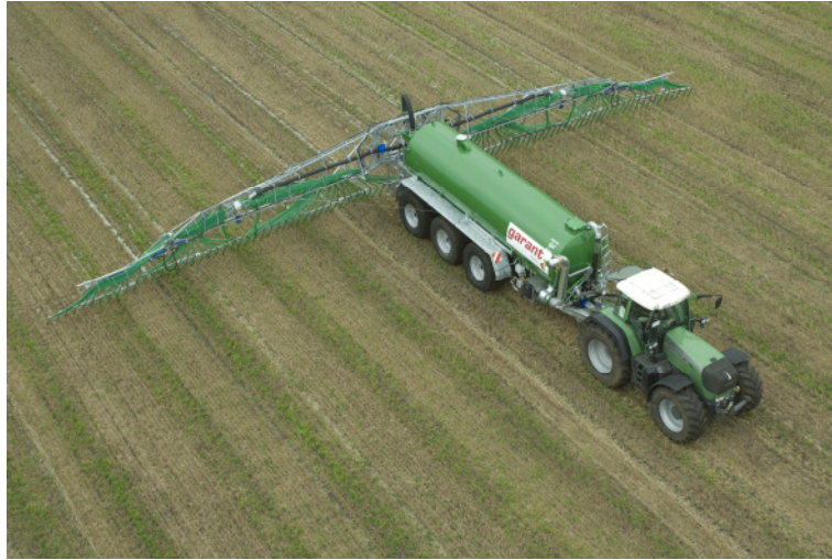
Bild 1: Schleppschlauchverteiler in 30 m Arbeitsbreite (Arbeitsstellung).
