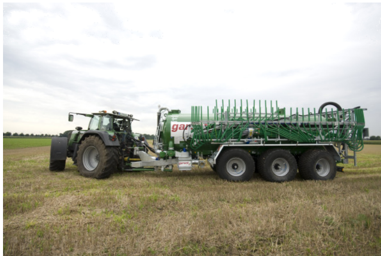
Bild 2: Schleppschlauchverteiler in 30 m Arbeitsbreite (Transportstellung).
