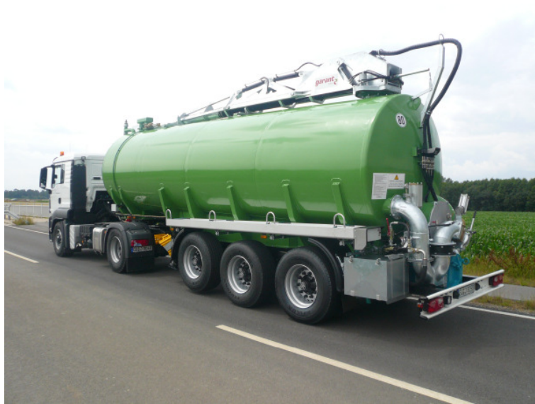
Bild 1: TSA 28.000 V mit Ansaugrüssel auf dem Behälter und Börger Drehkolbenpumpe im Heck
