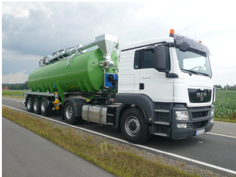
Bild 2: TSA mit Abtropfwanne (oben) und Öl-Luftkühler (unten)
