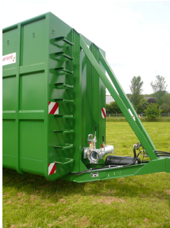
Bild 3: Aufstiegsleiter an der Stirnwand, T-Stück zum Ansaugen vorne links und rechts
