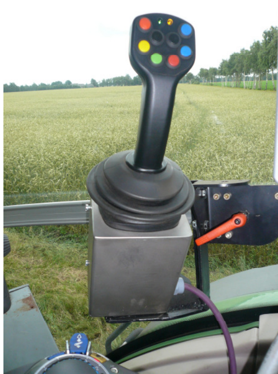
Bild 1: Multifunktionsgriff der Variante Profii mit zwei Achsen
