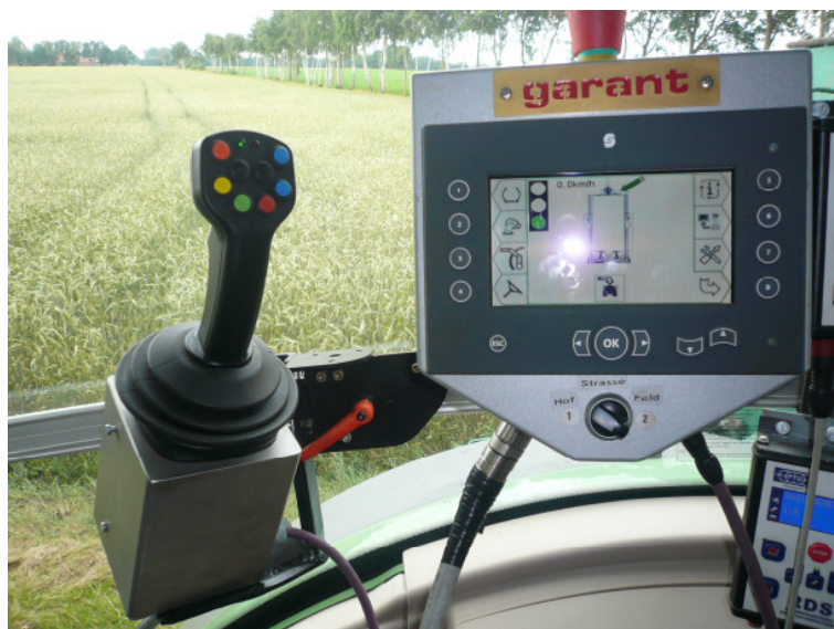
Bild 2: Multifunktionsgriff und Farbdisplay der Variante Profii
