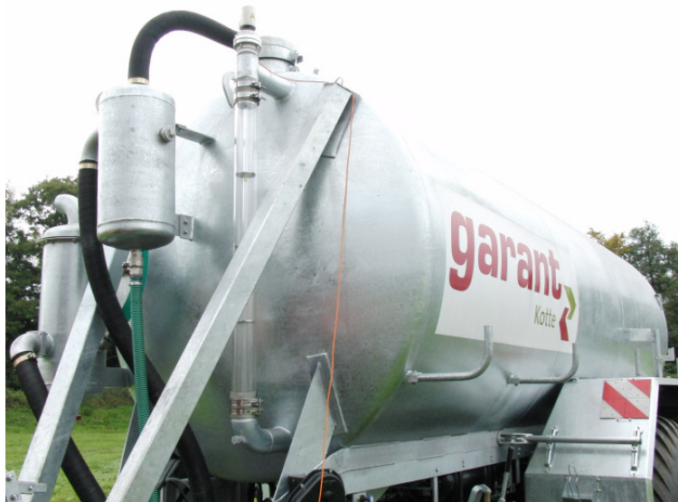
Bild 2: Steigrohr mit Messflüssigkeit am Prototypenfass
