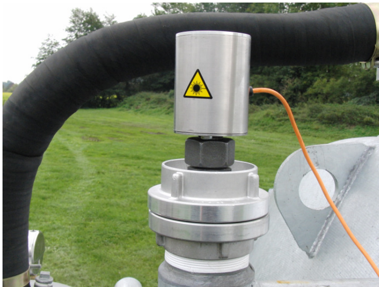
Bild 3: Messkopf des iTANK zur Bestimmung des Füllstandes mittels Lasersensor
