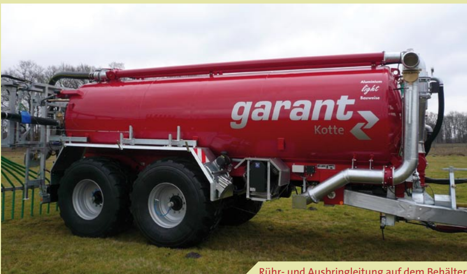
Rühr- und Ausbringleitung auf dem Behälter
