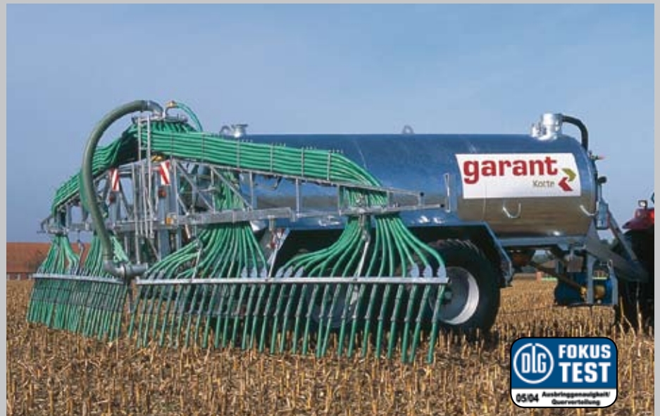
GARANT VT 14.000 cu distribuitor cu furtunuri cu o lățime de lucru de 15 m
