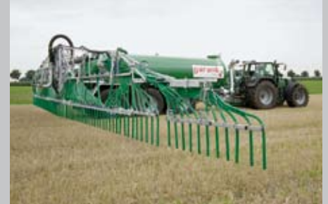
GARANT PTR 25.000 din aluminiu light cu distribuitor de furtunuri cu lățime de lucru de 27 m
