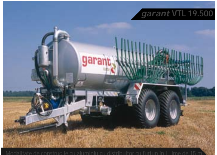
Modalitate de construcție cu aluminiu cu distribuitor cu furtun în lungime de 15 m.
