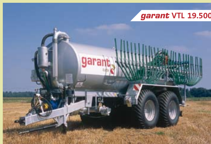
Aluminiowa konstrukcja z wleczonym rozdzielaczem węzowym o szerokości roboczej 15 m
