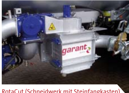
RotaCut (Schneidwerk mit Steinfangkasten)
