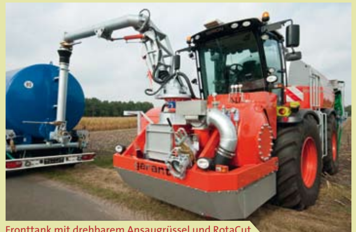
Fronttank mit drehbarem Ansaugrüssel und RotaCut
